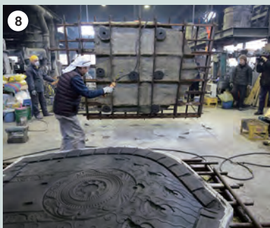
8 大光背の裏側の鑄型を表側と合わせる
