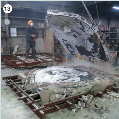
13 大光背の鑄型を吊り上げ、表面に残る鑄物砂を取り除く。釈迦三尊像光背銘をスクリーン印刷で転写し、筆勢や勢いを再現するため彫金の技術で一文字ずつ彫る
