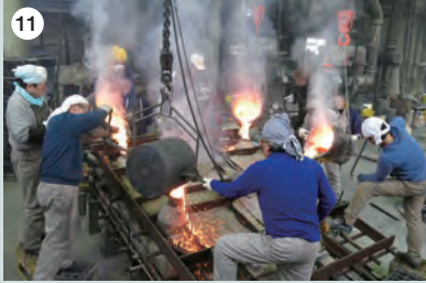
11 4つの湯口より注湯。注湯のタイミングは熟練した職人の勘所による
