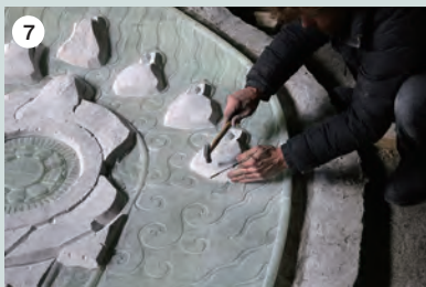
7 複雑な造形箇所は大小の型に分割し、組み立てて鑄型にする
